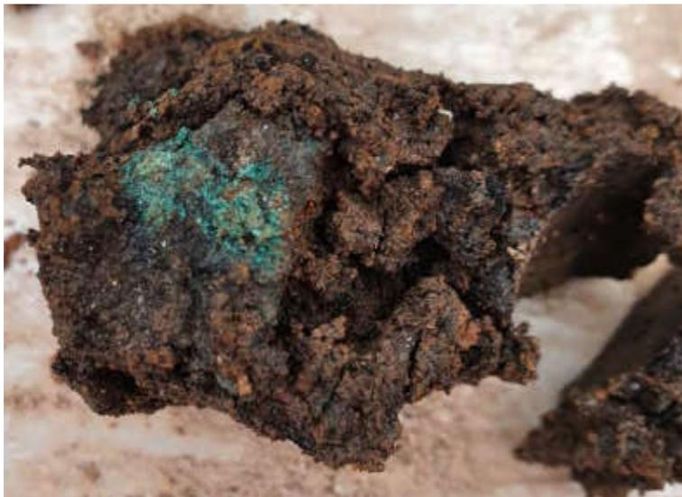
Abbildung 15 RKS 1, Probe 1.2, Schlacke-/Ascheauffüllung mit grünen Verfärbungen im 2.Bohrmeter
