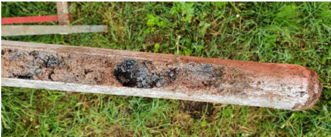
Abbildung 13 Verölungen im 4.Bohrmeter, RKS 7 (3,70-3,90 m uGOK)
