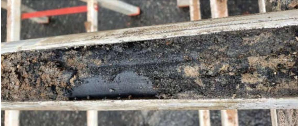
Abbildung 16 typische Ascheablagerung in der Auffüllung, hier: RKS 2, erster Bohrmeter
