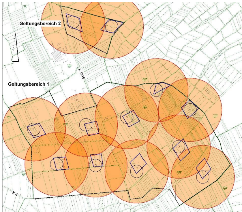
Abb. 10: Beispielanordnung innerhalb der Baufelder, Darstellung der Abstandsfelder (Radius der Abstandsfelder = 375 m, Rotorradius der Beispielanlagen = 75 m)
